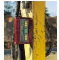
FMR600 con imanes adosado a un brazo excavador
