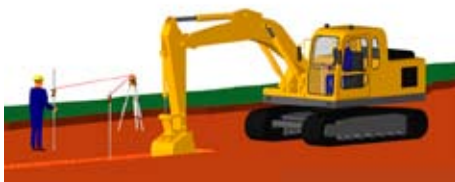
Verificación de excavación
